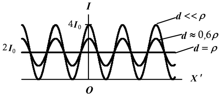
Рис.2.7. Распределение по оси  $X'$  интенсивности интерференционной картины для трех значений расстояния между щелями
